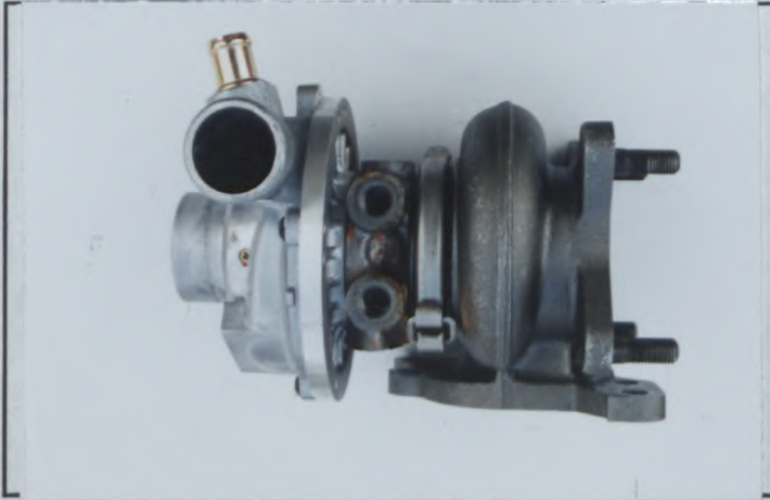
K) Vue de dessus du turbocompresseur Plan view of turbocharger タボチャージャーの上面視
