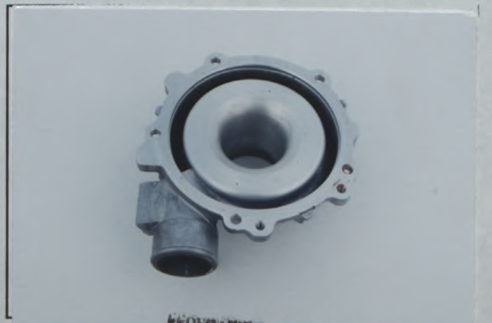
Q) Carter de compression du turbocompresseur Compressor housing of turbocharger ターボチャージャーのコンプレッサハウジング
