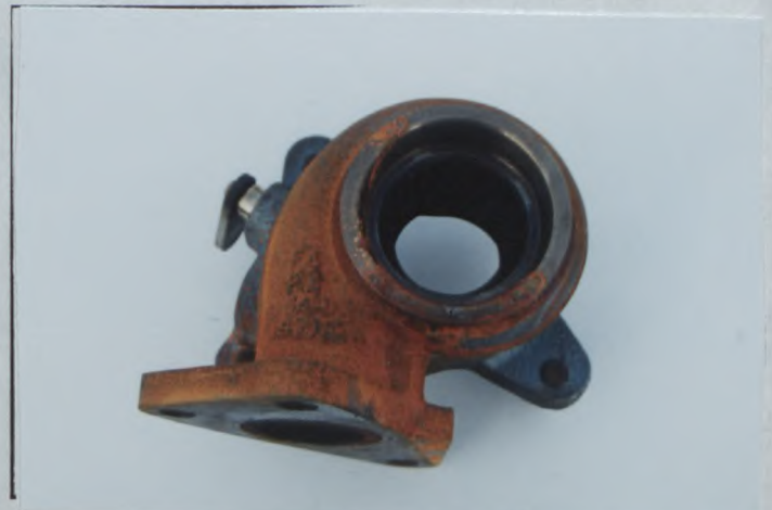
Q) Carter de compression du turbocompresseur Compressor housing of turbocharger ターボチャージャーのコンプレッサハウジング
