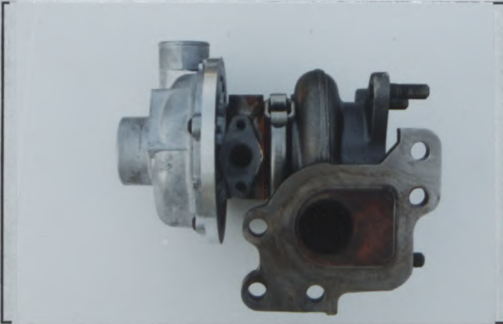
M) Vue de côté du turbocompresseur Side view of turbocharger タボチャージャーの側面視
