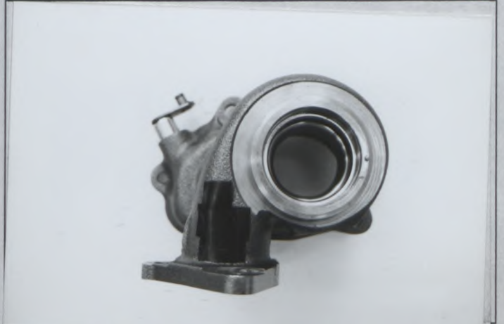
N) Carter de turbine du turbocompresseur Turbine housing of turbocharger ターボチャージャーのタービンハウジング
