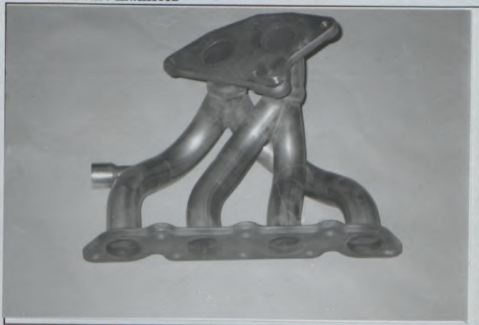
J) Collecteur d'échappement Exhaust manifold
