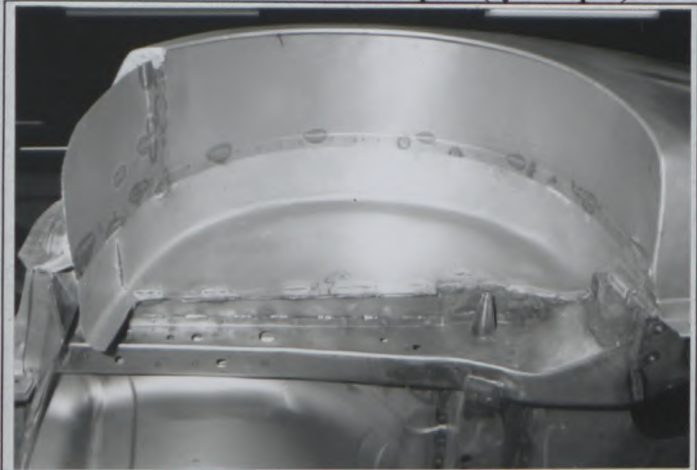
A7) Passage de roue arrière avec les pièces montées Rear wheel arch with assembled parts (Symétriques)
