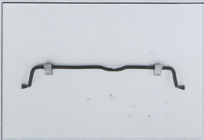
XI) Dessin ou photo du stabilisateur avant Drawing or photo of front stabiliser
