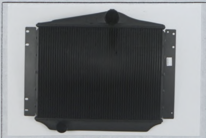
R) Echangeur intermédiaire déposé Intercooler dismantled
