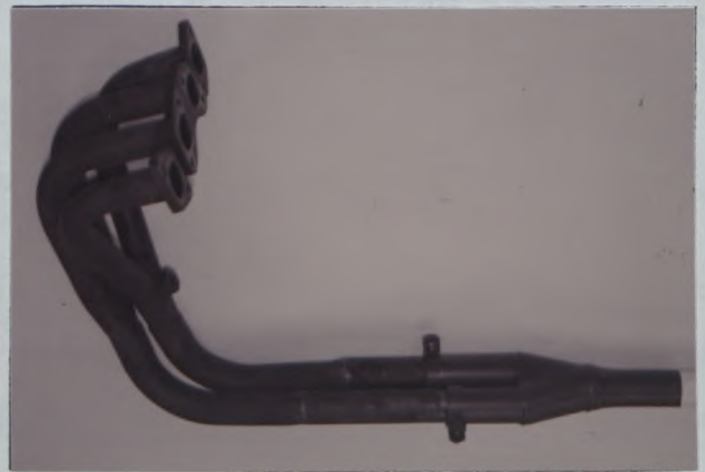
J) Collecteur d'échappement Exhaust manifold
