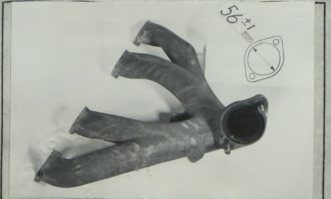
Q, Exhaust manifold 排気マニホールド
