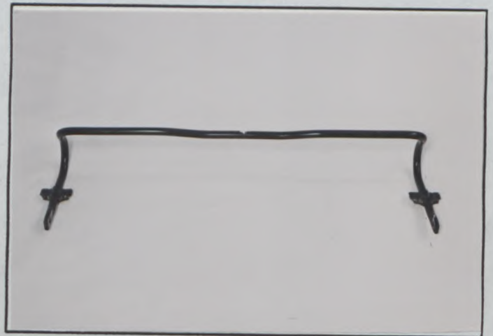
XI) Dessin ou photo du stabilisateur arrière Drawing or photo of rear stabiliser
