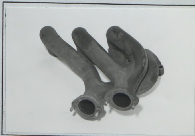
J) Collecteur d'échappement Exhaust manifold
