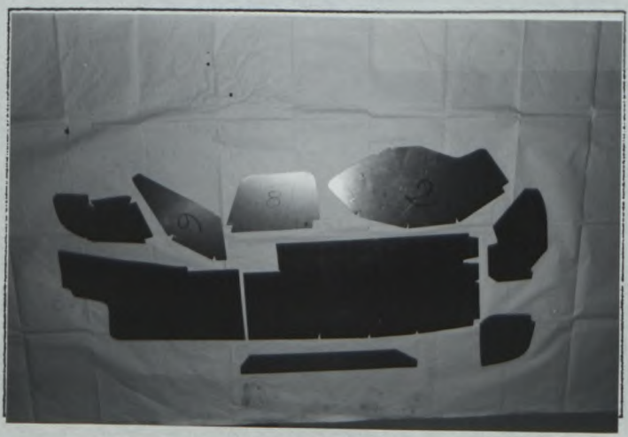
A5) Pièces démontées du passage de roue avant Front wheel arch dismantled parts
