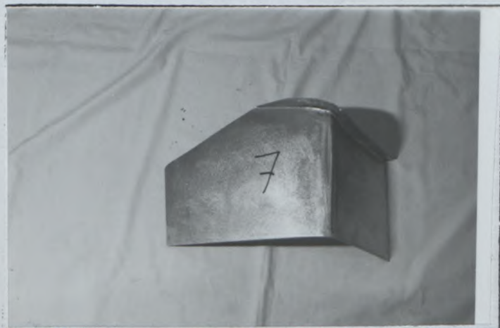
A5) Pièces démontées du passage de roue avant Front wheel arch dismantled parts
