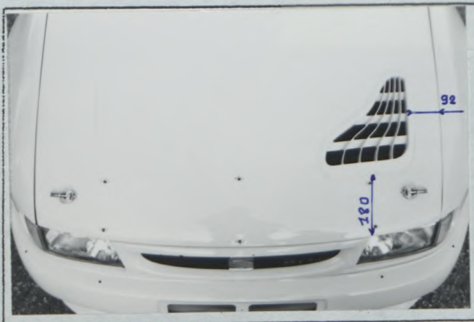
Section d'ouverture = 369 cm 2 Opening section = 369 cm 2
