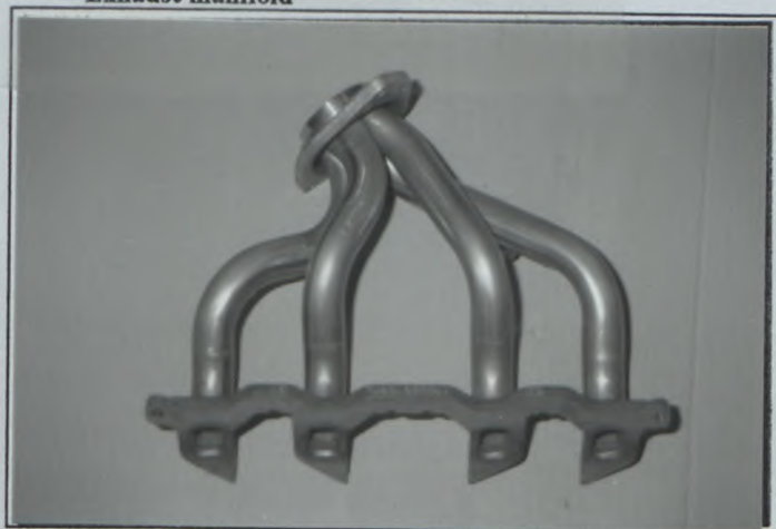
J) Collecteur d'échappement Exhaust manifold
