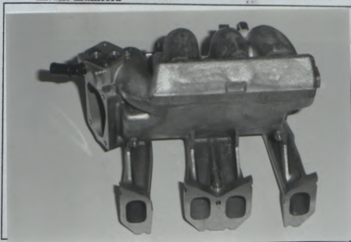
D) Collecteur d'admission Intake manifold
