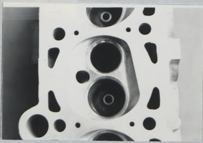
G) Chambre de combustion Combustion chamber
