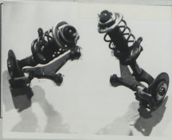
T) Train avant complet déposé Complete dismantled front axle
