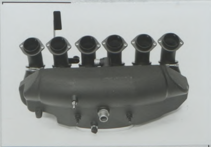
i) Einlaßkrümmer Intake manifold
