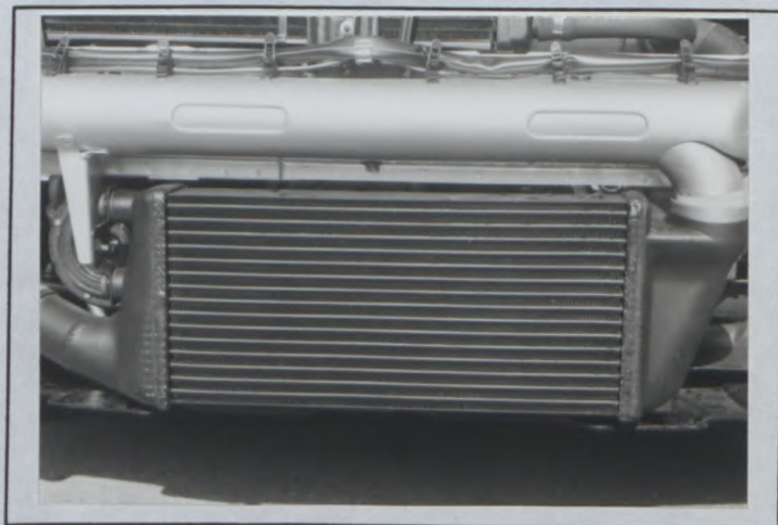
Z) Echangeur intermédiaire monté Intercooler mounted
