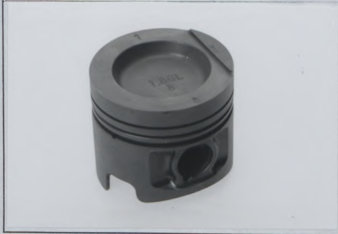
AA) Seitenansicht des Kolbens Piston profile
