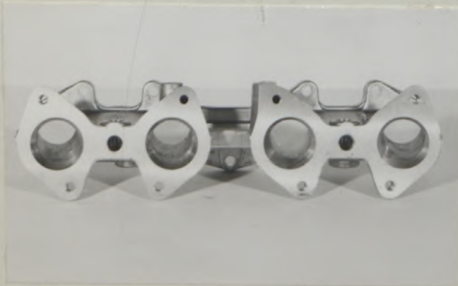
P, Inlet manifold
