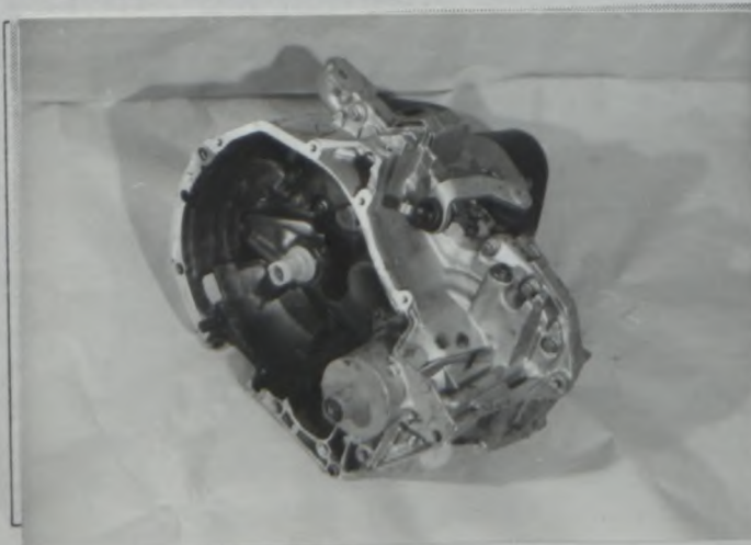
S) Carter de boîte de vitesse et cloche d'embrayage Gearbox casing and clutch bellhousing
