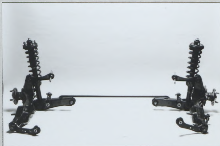
U) Complete dismantled rear running gear 車両から取外したリヤー走行装置一式
