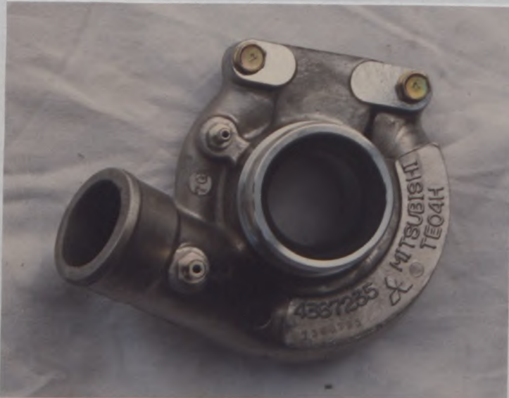
Q) Carter de compression du turbocompresseur Impeller housing of turbocharger
