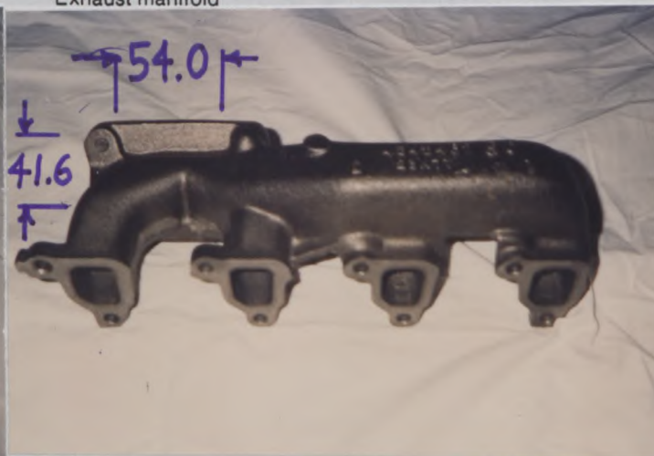
J) Collecteur d'échappement Exhaust manifold
