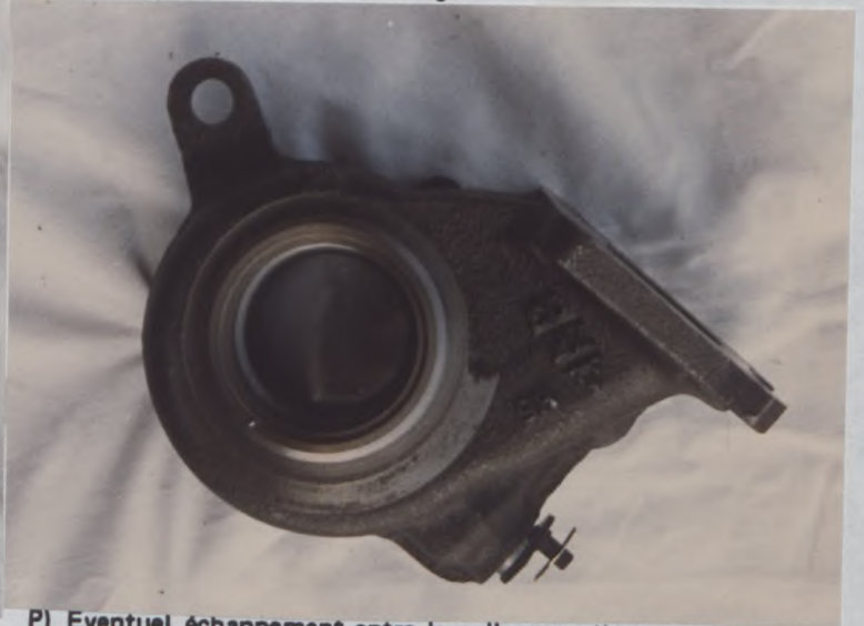
P) Eventuel échappement entre le collecteur d'échappement et le turbocompresseur. Eventual exhaust pipes between the exhaust manifold and the turbocharger.
