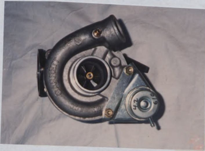
M) Vue de côté du turbocompresseur Side view of turbocharger
