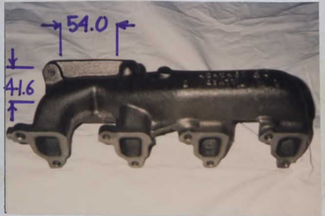
J) Collecteur d'échappement Exhaust manifold
