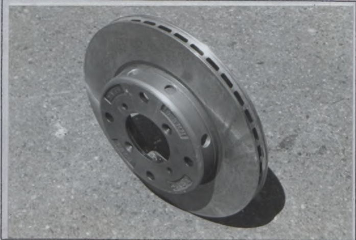
PHOTO VW1 FR/RR BRAKE DISC, TYPE A
