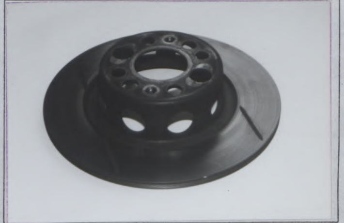
PHOTO VW4 FR/RR BRAKE DISC, TYPE B
