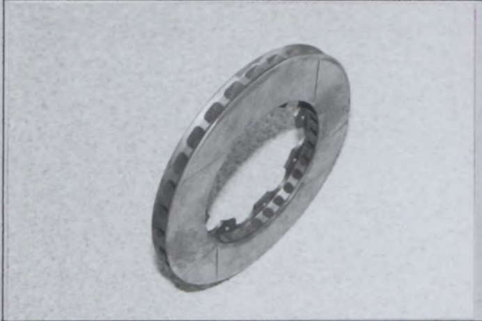
PHOTO VW3 FR/RR BRAKE DISC, TYPE A
