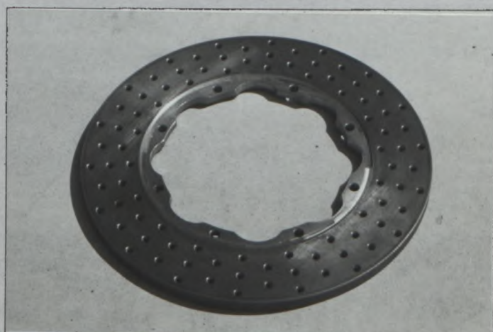
Photo VW5 FR/RR BRAKE DISC, TYPE B
