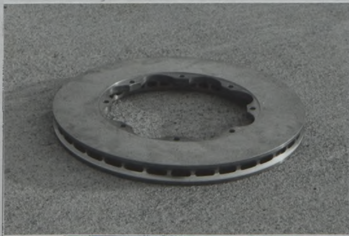
Photo VW4 FR/RR BRAKE DISC, TYPE A
