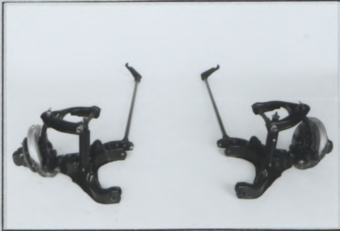
T) Complete dismantled front running gear 車両から取外したフロント走行装置一式
