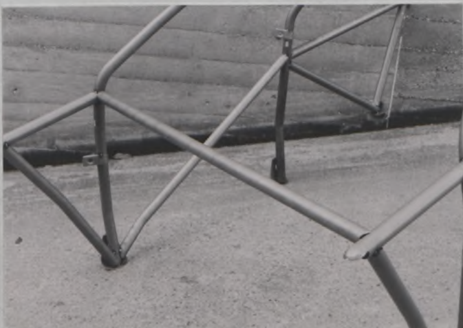
Wahlweise Querstrebe im Vorbau. Optional brace in the front.
