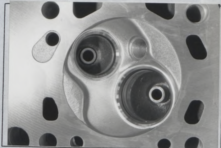
G) Chambre de combustion Combustion chamber
