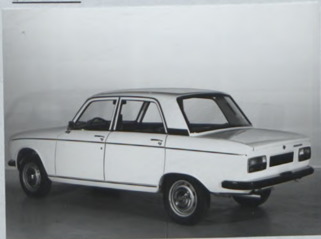
Sorties d'air sur custodes et nouveaux feux AR
