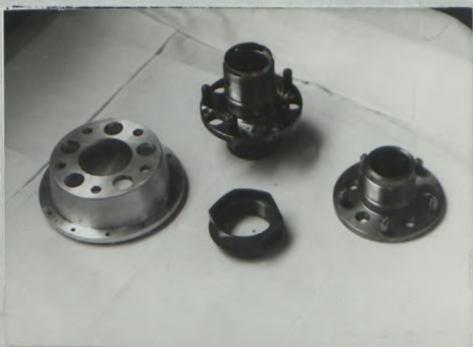
n°5) Fixation roues avec écrou centrale
