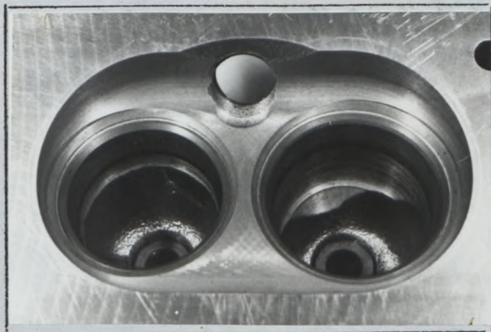
G) камера сгорания Chambre de combustion
