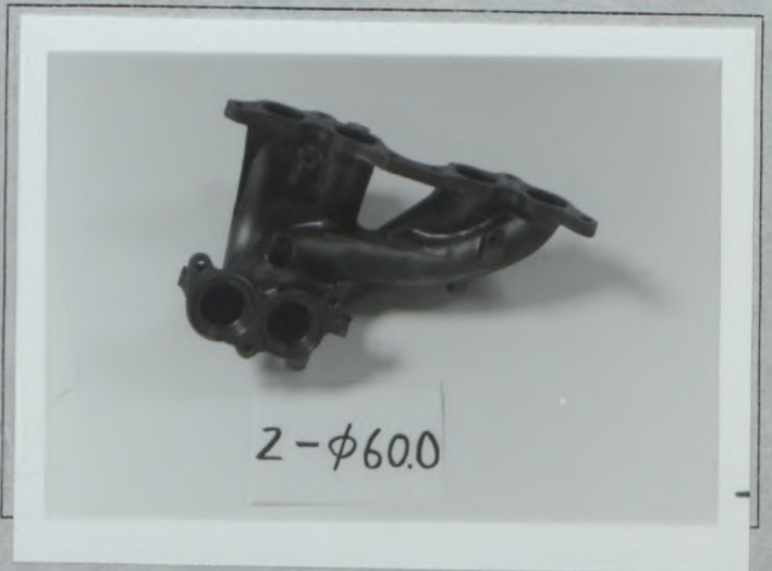
J) Exhaust manifold エキゾーストマニホールド
