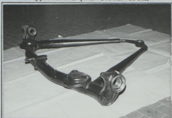
Renforcement pour N.29) Stabiliseur AV à barre de torsion
