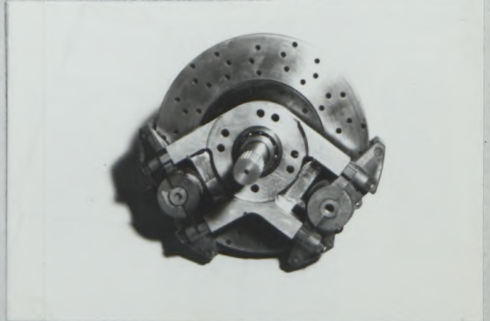
n°16) Assemblage deuxième étrier pour frein de stationnement
