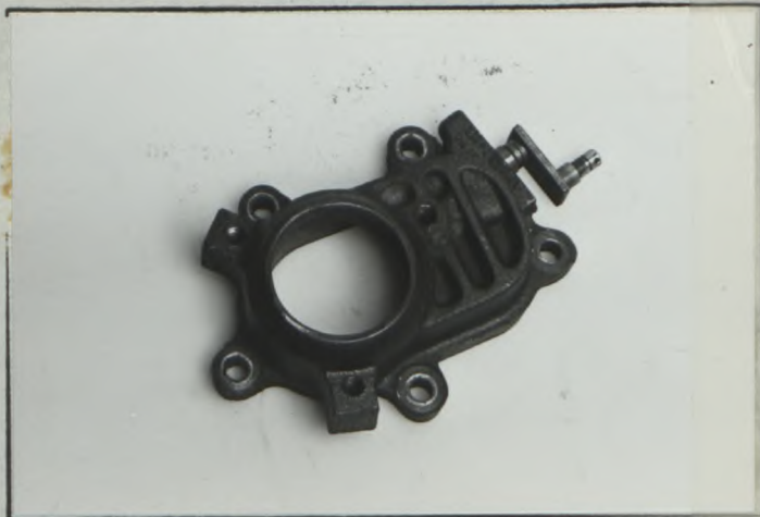
O) Soupape et montage du by-pass du turbocompresseur Valve and by-pass installation of turbocharger
