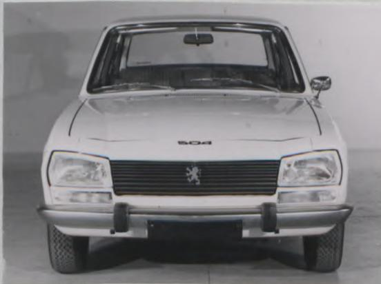
Montage des projecteurs à simple parabole en remplacement des projecteurs combinés à iode.
