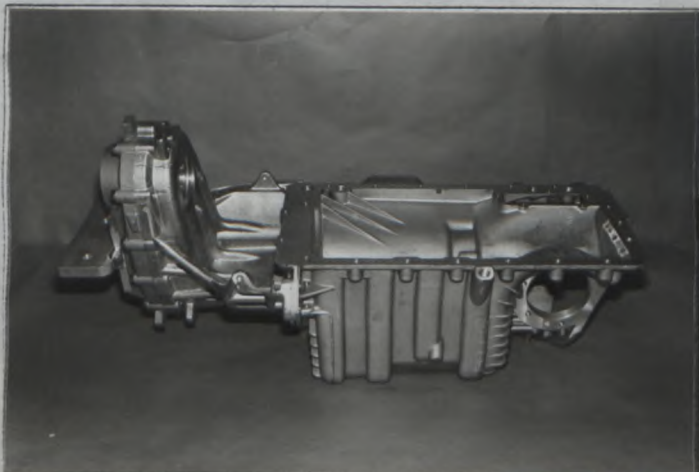
S) Carter de boîte de vitesse et cloche d'embrayage Gearbox casing and clutch bellhousing
