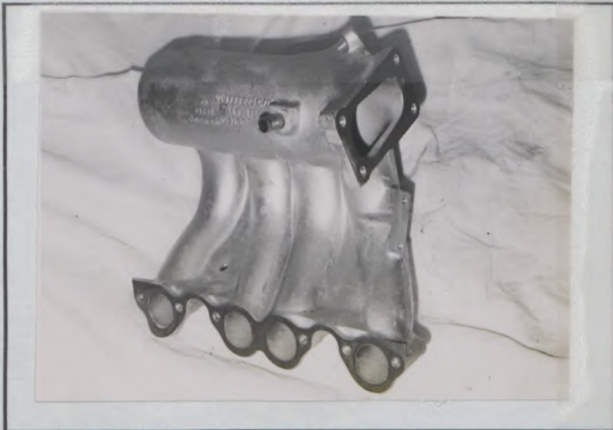
I) Einlaßkrümmer Inlet manifold
