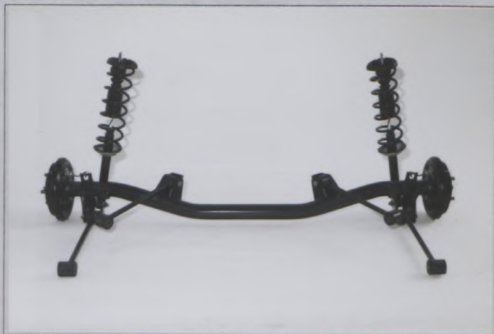
U) Complete dismantled rear running gear 車両から取外したリヤ走行装置一式
