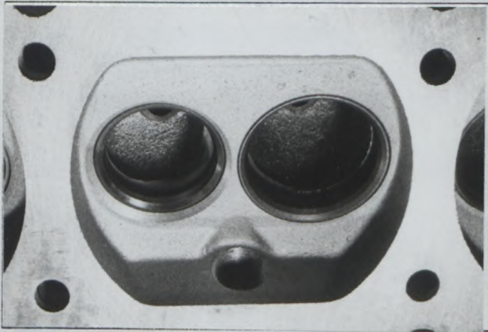
G) Chambre de combustion Combustion chamber
