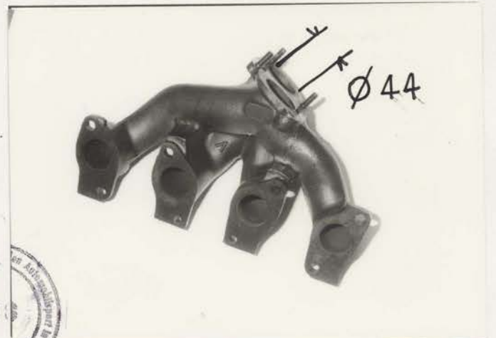
J) Auspuffkrümmer Exhaust manifold
