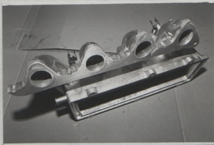
I) Collecteur d'admission Inlet manifold
