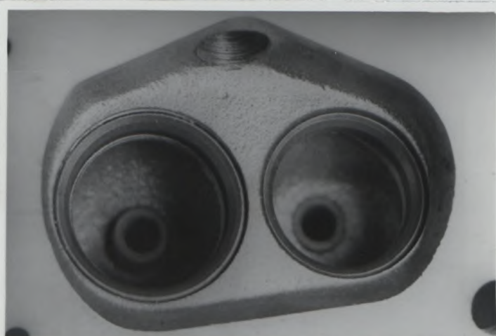
G) Chambre de combustion Combustion chamber
