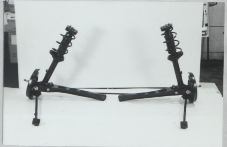
U) Complete dismantled rear running gear 車両から取外したリヤ走行装置一式
