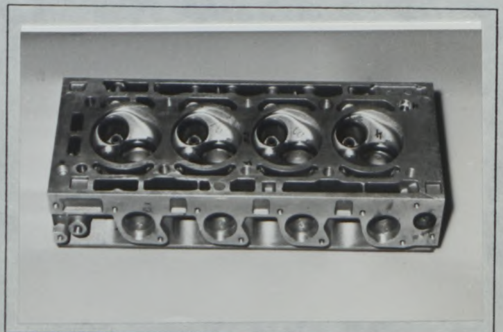
F) Culasse nue Bare cylinderhead
