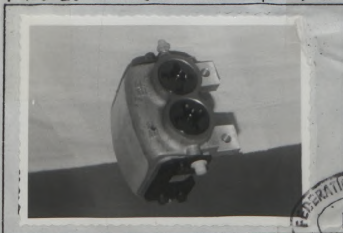
Photo 2 e : étriers Lockheed 4 cyl. A.V.
