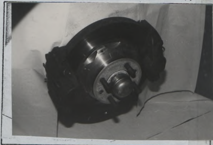
Photo 4 e disques Lockheed ventilés A.V
