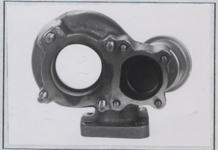
P) Auslaß zwischen Auspuffrohr und Lader Exhaust between the manifold and the turbocompressor
