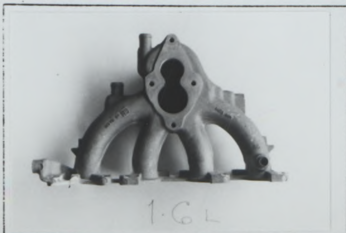
I) Collecteur d'admission Inlet manifold
