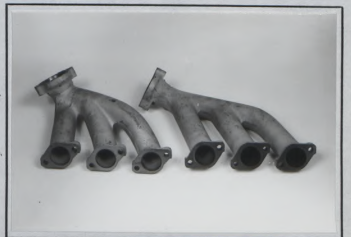
J) Auspuffkrümmer Exhaust manifold
