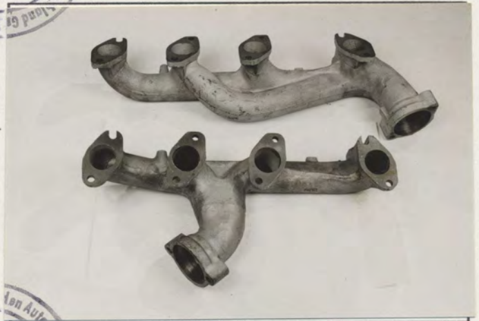
J) Auslaßkrümmer Exhaust manifold
