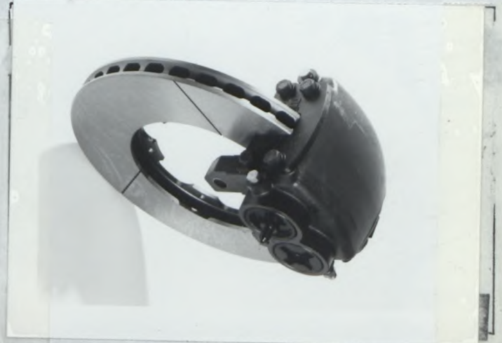
Photo 3 e : étrier A.T.E. avec fr. de stationnement AR.
