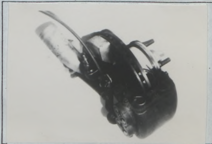
Photo 1 a : disques Lockheed ventilés A.V.
