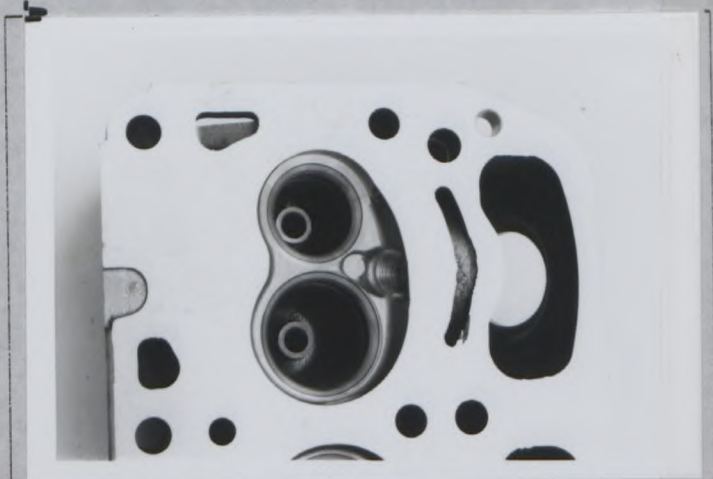
G) Combustion chamber 燃焼室
