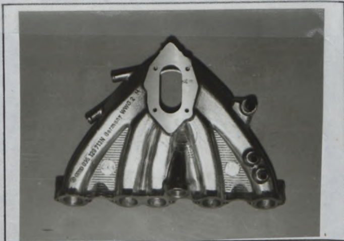
I) Einlaßkrümmer Inlet manifold
