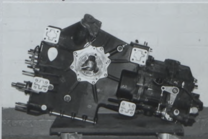
S) Carter de boîte de vitesses / Gearbox casing
